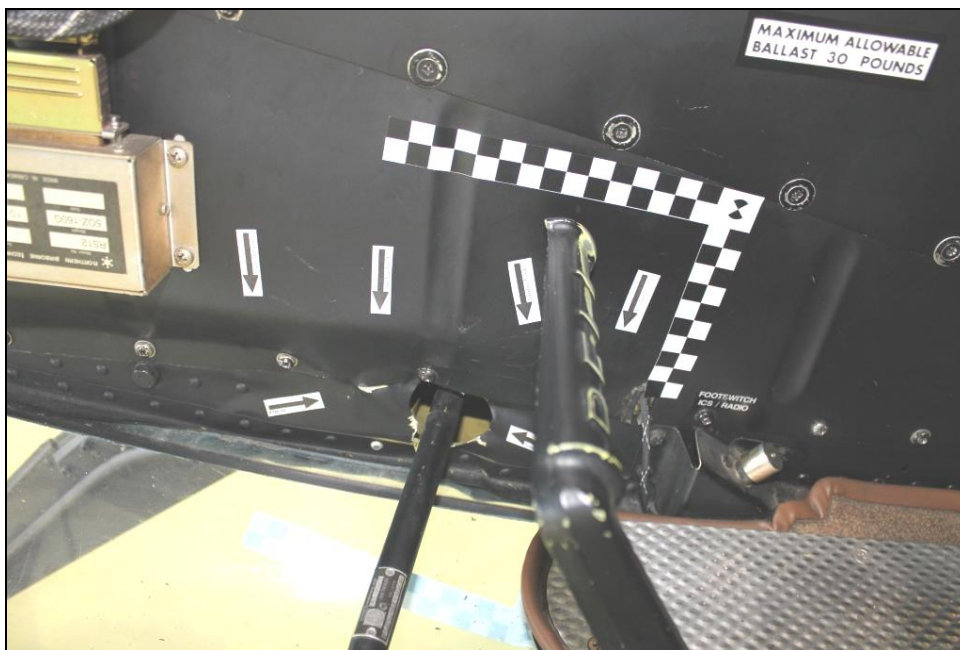
Slika 6: Poškodbe centralnega nosilca konstrukcije pilotske kabine (vitalni del helikopterja)
