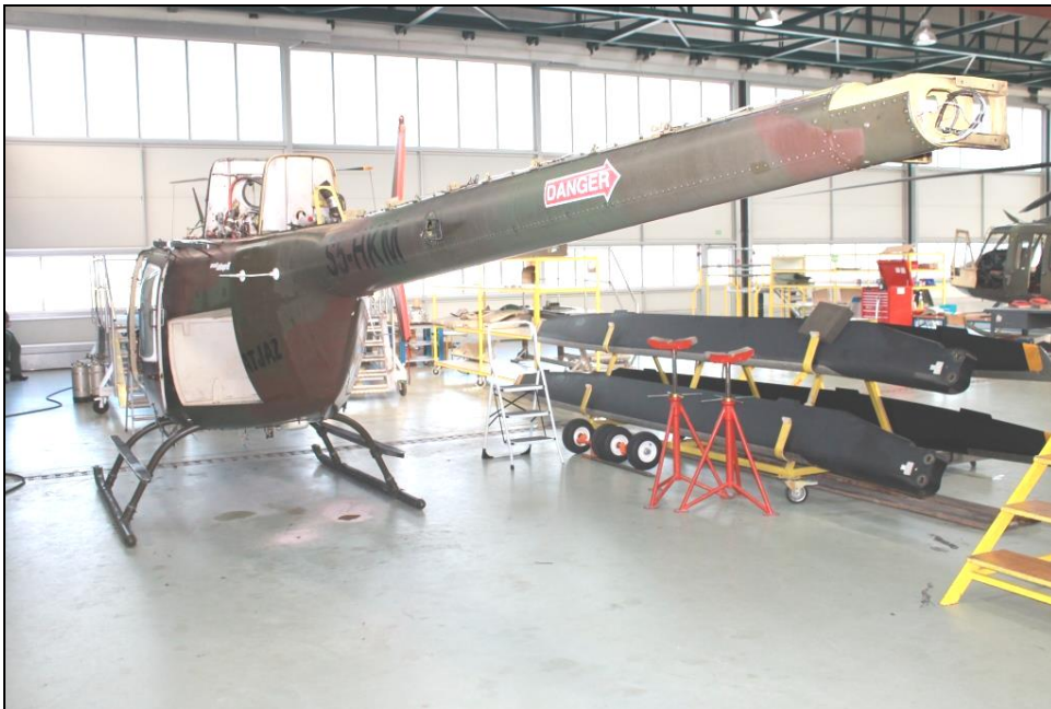
Slika 9: Vitalni deli helikopterja (motor, reduktor glavnega rotorja, glava glavnega rotorja, gred glavnega rotorja) so bili sneti iz helikopterja in poslani na generalno obnovo
