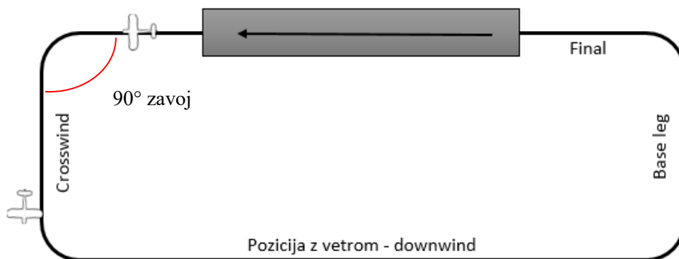
Slika 22: Standardni šolski krog za vzletanje in pristajanje v VMC razmerah
