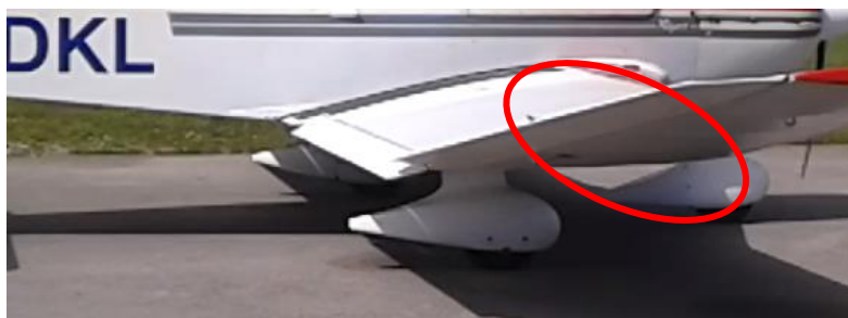
Slika 17: Nastavitev zakrilc letala
