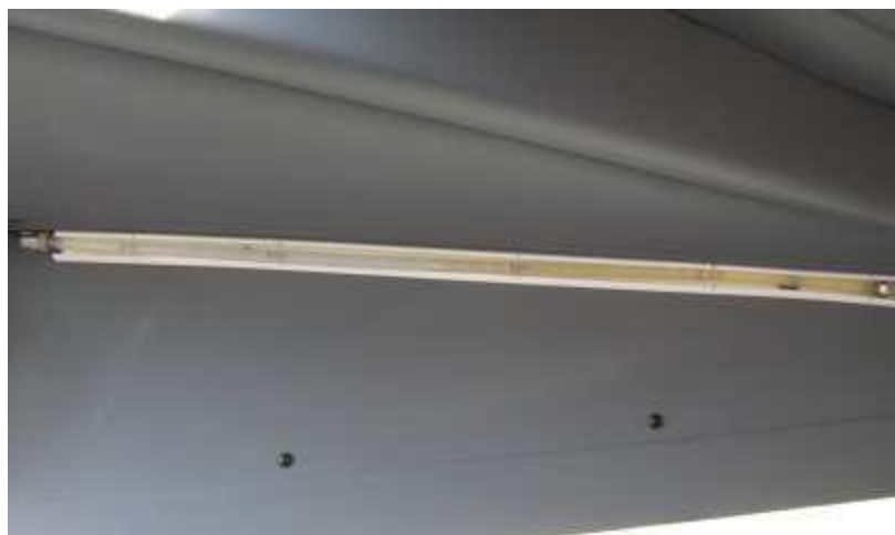
Slika 2: Indikator količine goriva v obliki prosojne cevi v pilotski kabini
