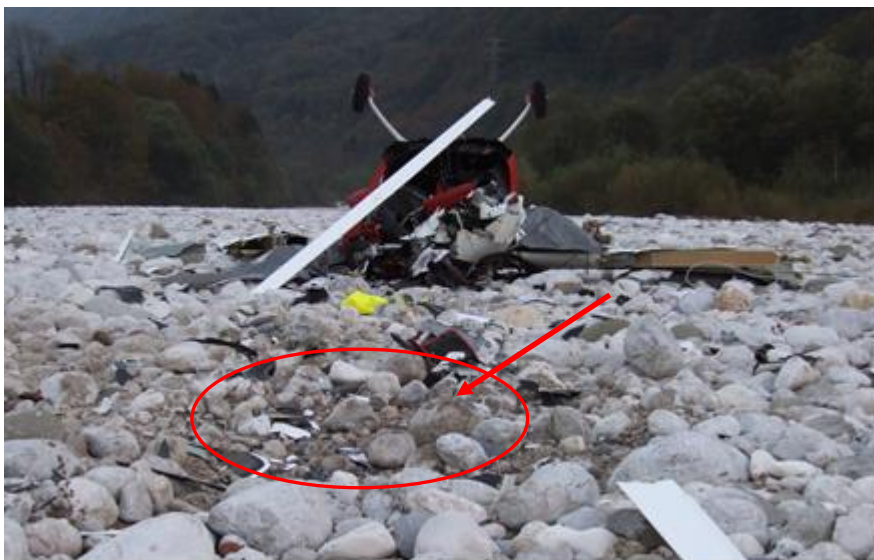
Slika 2: Mesto trka – krater v velikosti 2 m × 2 m (posnetek v smer trka)
