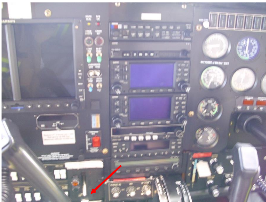
Slika 5. Ročica za spuščanje koles v položaju DOWN
