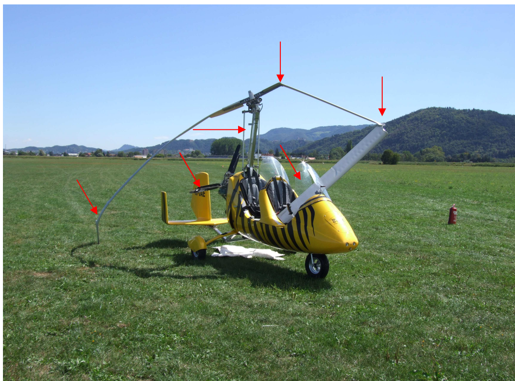
Slika 2. Prikaz poškodb giroplana S5-JAE
