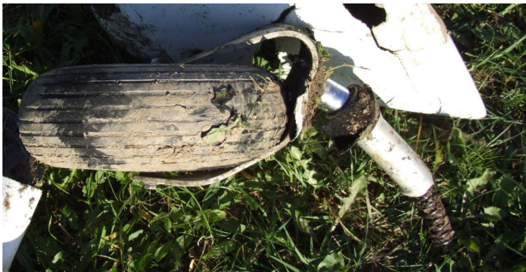
Slika 2. Zlom nosilca in blažilca nosne noge pristajalnega podvozja
