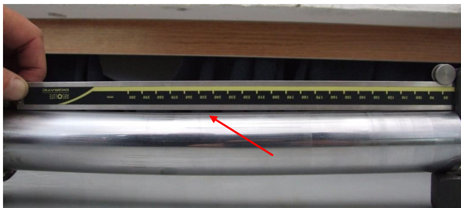
Slika 16. Upognjen bat blažilca leve noge LDG
