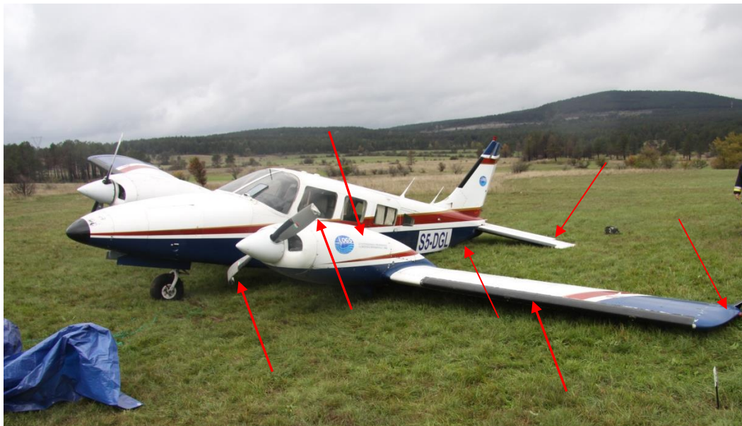
Slika 1. Letalo na mestu popolne ustavitve po izletu s VPS – poškodbe
