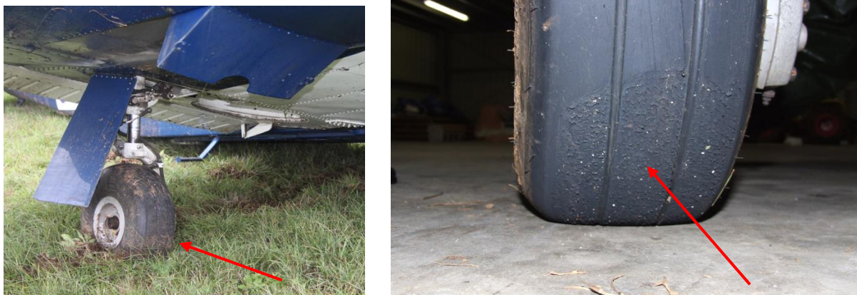
Slika 11. Sledi vodnega klina na pnevmatiki desne noge LG
