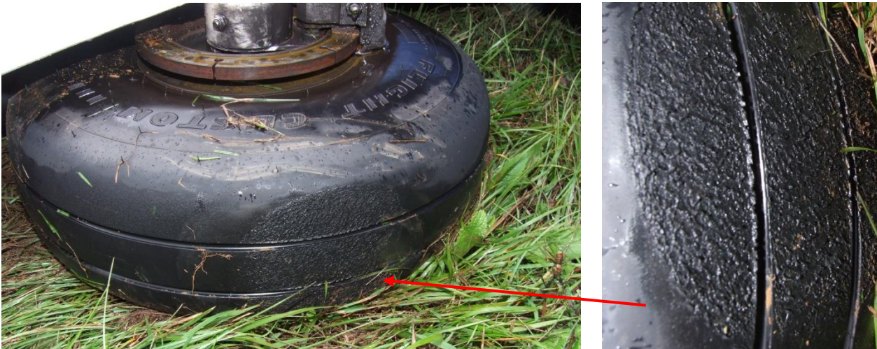
Slika 10. Sledi vodnega klina na pnevmatiki leve noge LG
