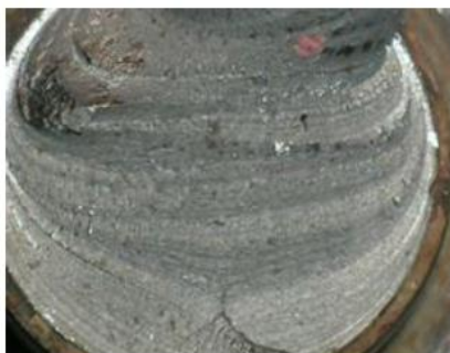
Slika 9. Značilne linije utrujanja pri utrujenostnem lomu
