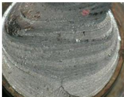
Slika 9. Značilne linije utrujanja pri utrujenostnem lomu
