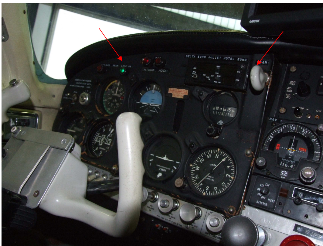
Slika 8. Položaj stikala "podvozje spuščeno" in zelena signalizacija "podvozje spuščeno in zaklenjeno"
