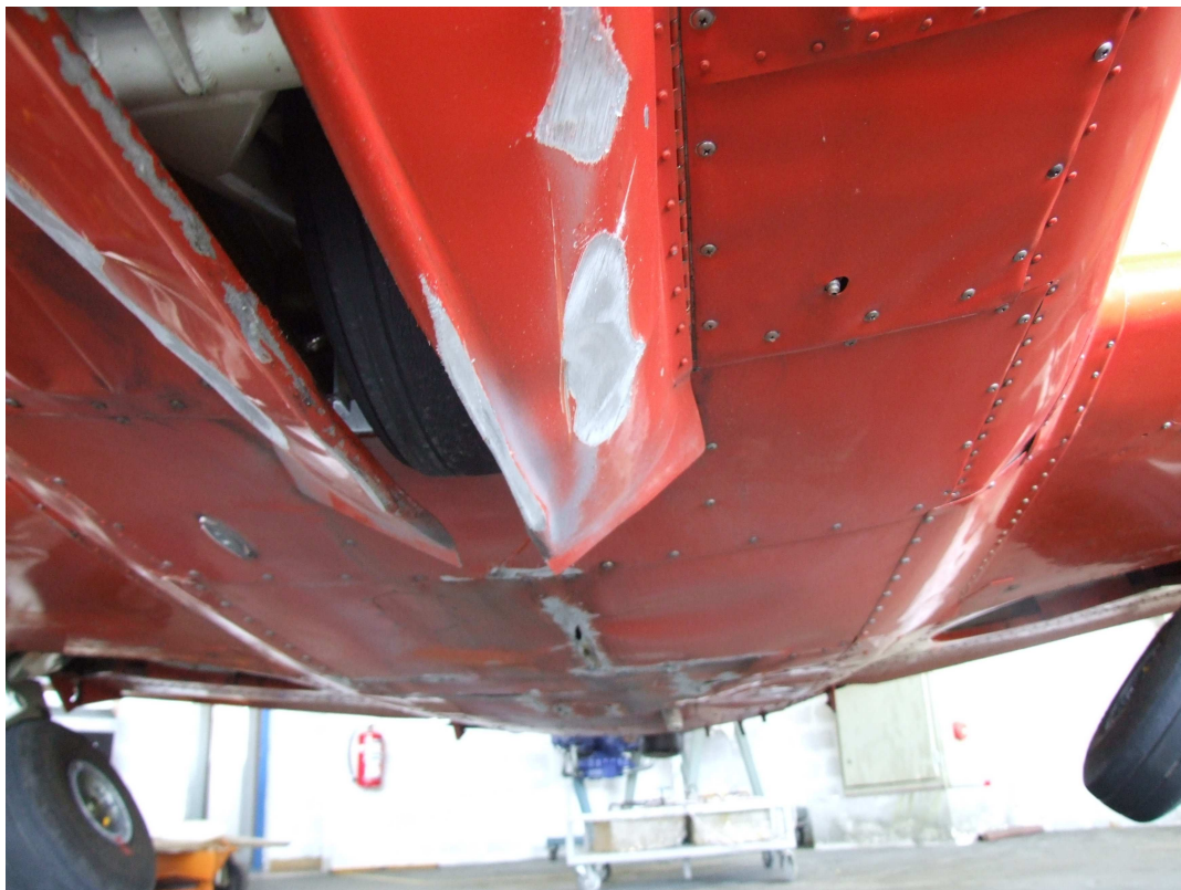
Slika 2. Poškodbe spodnje strukture trupa letala
