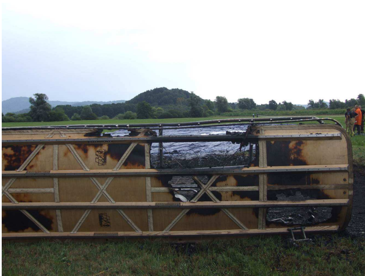
Slika 3: Poškodbe balona S5-OLO na mestu popolne zaustavitve
