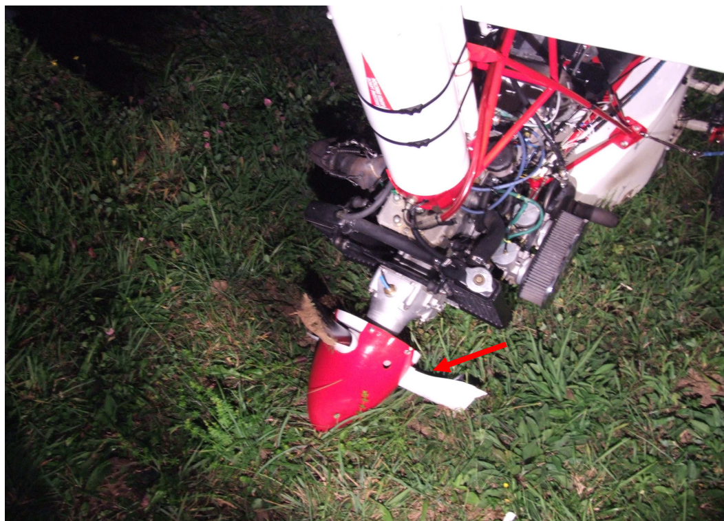
Slika 4. Poškodbe propelerja, trupa in podvozja letala
