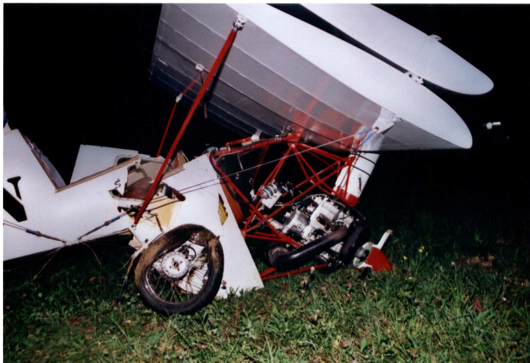
Slika 4. Poškodbe propelerja, trupa in podvozja letala
