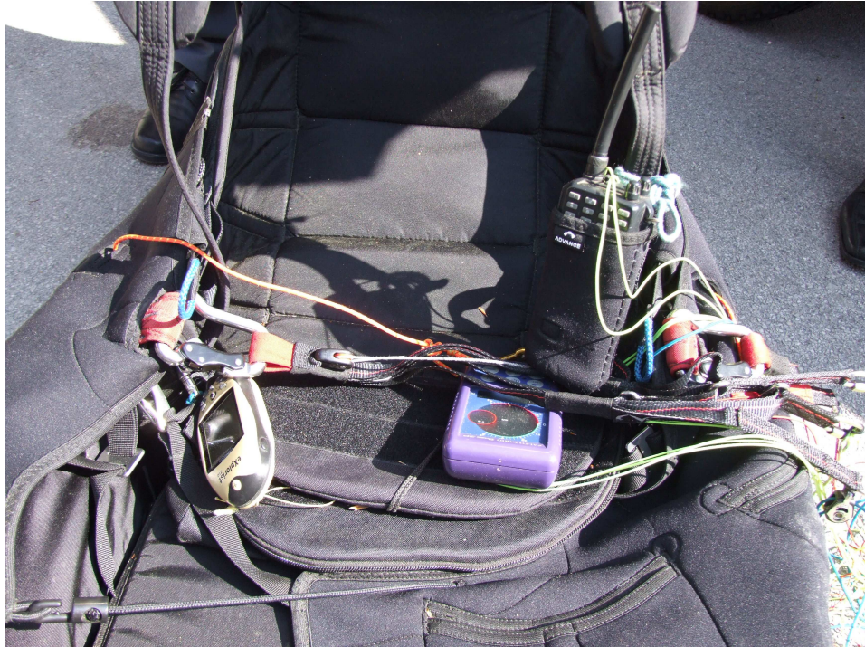
Slika 3: Letalni sedež, radijska postaja, GPS naprava in variometer
