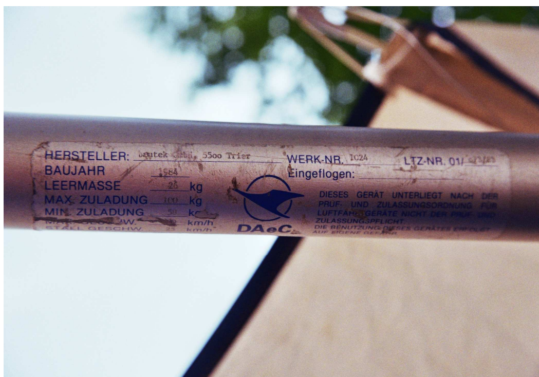
Slika 5. Identifikacijska nalepka proizvajalca na vzdolžni cevi jadralnega zmaja
