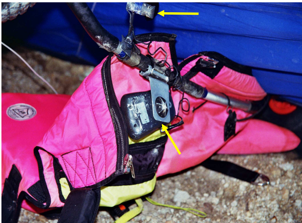
Slika 9. Višinomer na jadralnem zmaju s tipalom za merjenje prave zračne hitrost (TAS)
