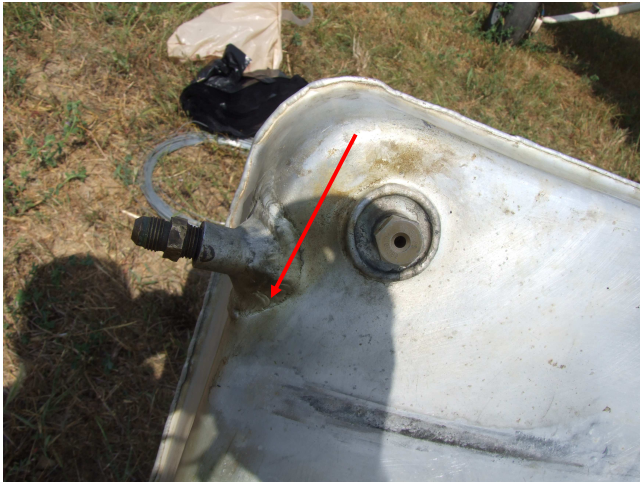
Slika 3. Puščanje goriva na desnem rezervoarju
