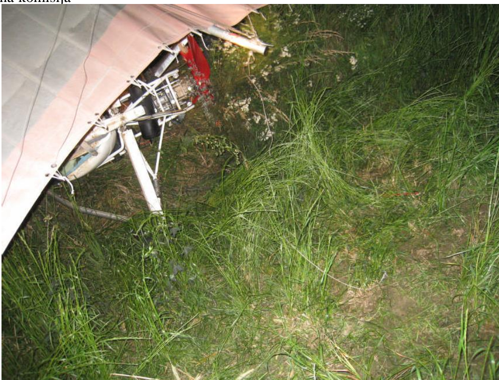
Slika 2: Temnejši madež v okolici motorja so sledovi razlitega goriva, vidne so tudi poškodbe krakov propelerja, ki nakazujejo na delovanje motorja ob udarcu v tla.
