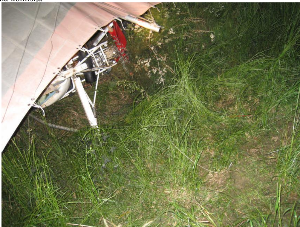
Slika 4: Na sliki je razvidna odtrgana žica, ki omogoča vodenje ULN motornega zmaja. Takšna poškodba krila bi onemogočila sam vzlet.
