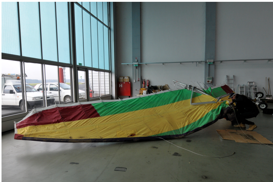
Slika 4: Na sliki je razvidna poškodba – deformacija zmaja na nosu.
