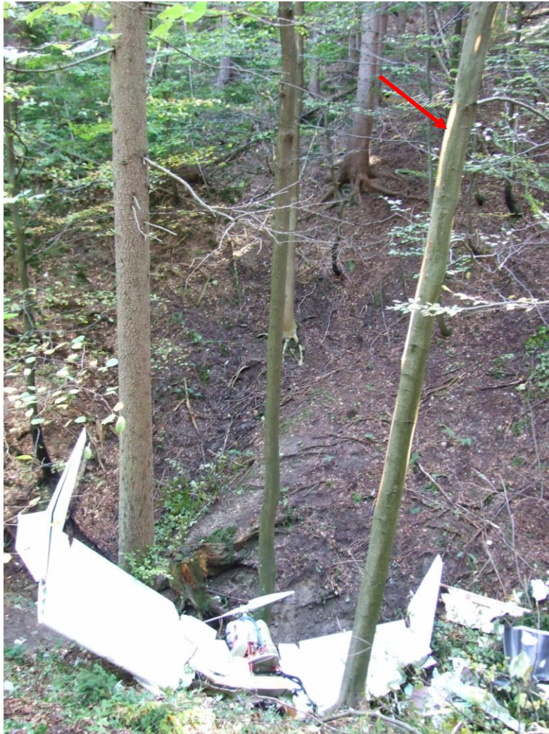
Slika 7. Sledi vertikalnega padanja letala na drevesu
