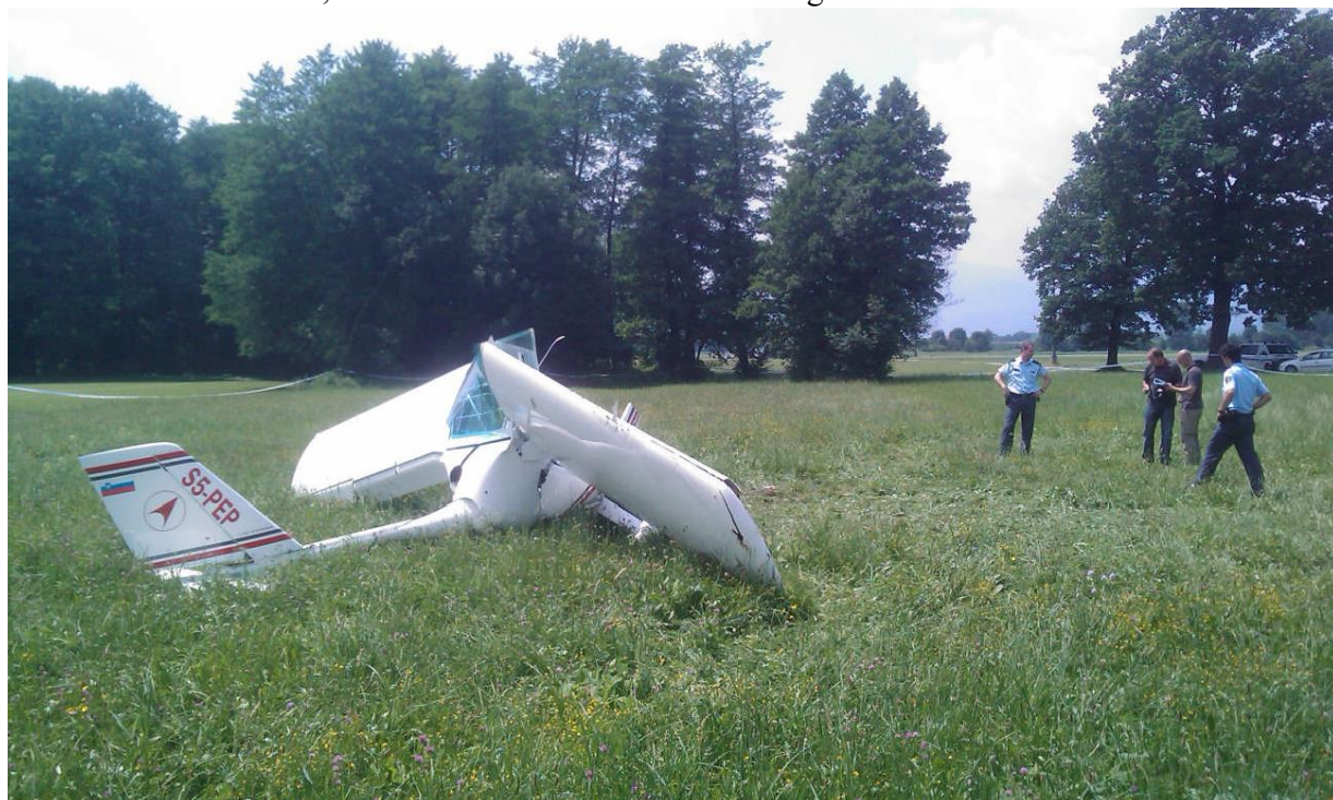
Slika 2: Na sliki se vidi, da so bila zakrilca ob udarcu desnega krila ob tla delno še izvlečena.
