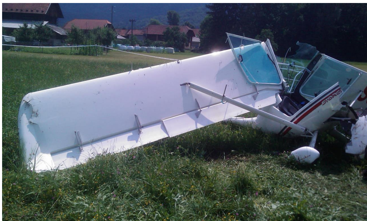
Slika 2: Na sliki se vidi, da so bila zakrilca ob udarcu desnega krila ob tla delno še izvlečena.
