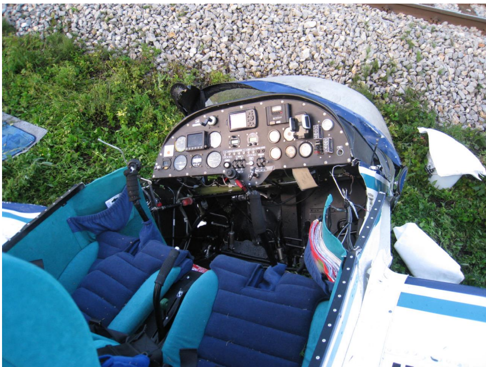
Slika 1.: Položaj letala po nesreči in položaj vzvodov ob prihodu komisije. Ročica koraka propelerja je zgoraj levo na armaturni plošči.
