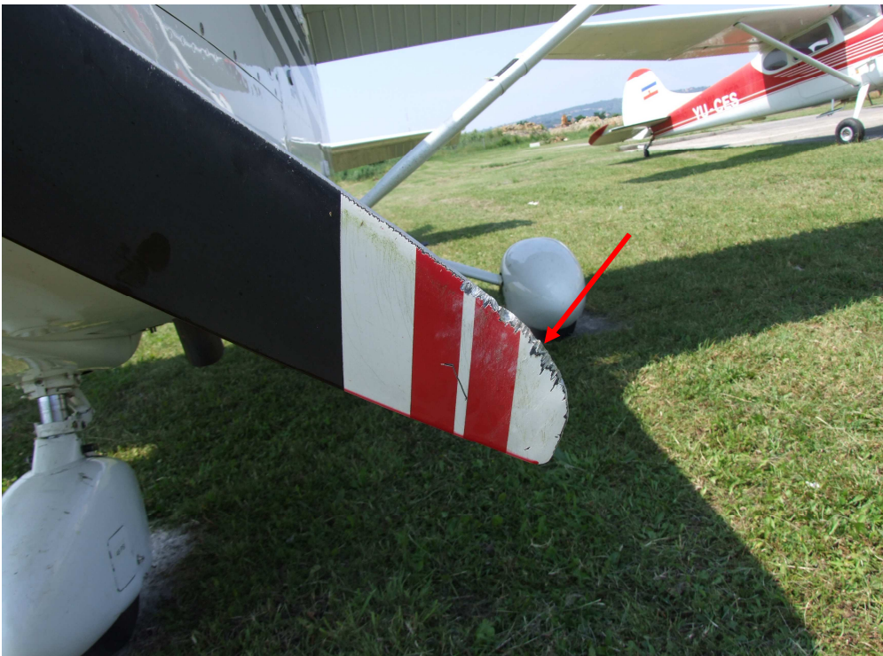
Slika 4. Poškodbe kraka propelerja
