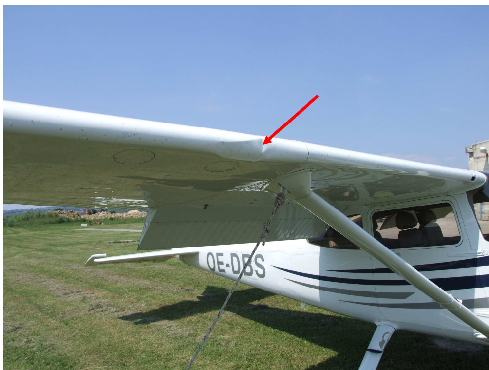
Slika 6. Poškodba sprednjega roba desnega krila
