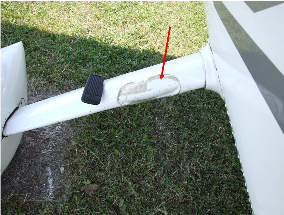
Slika 3. Poškodba opornice desnega glavnega podvozja
