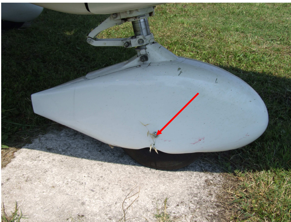
Slika 2. Poškodba zaščitnega pokrova nosnega kolesa
