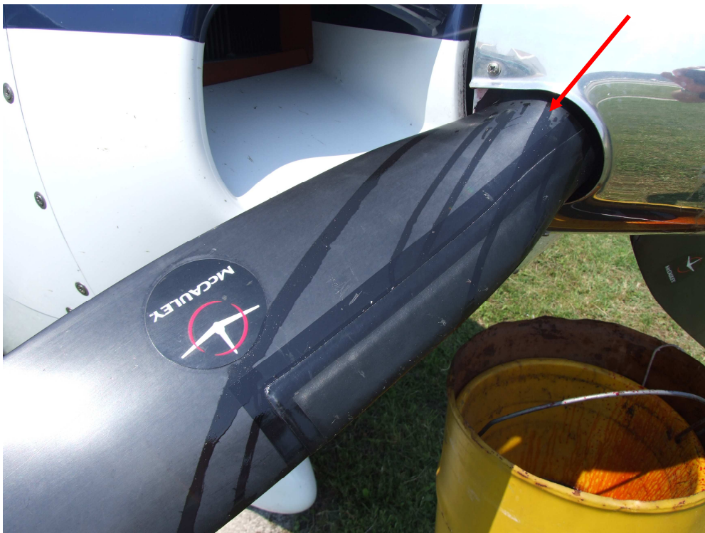
Slika 5. Poškodbe krakov propelerja – po trčenju vidne sledi puščanje olja
