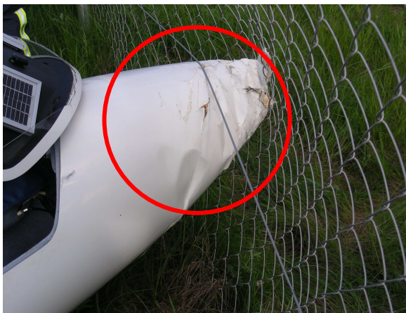
Poškodovana struktura nosnega dela letala
