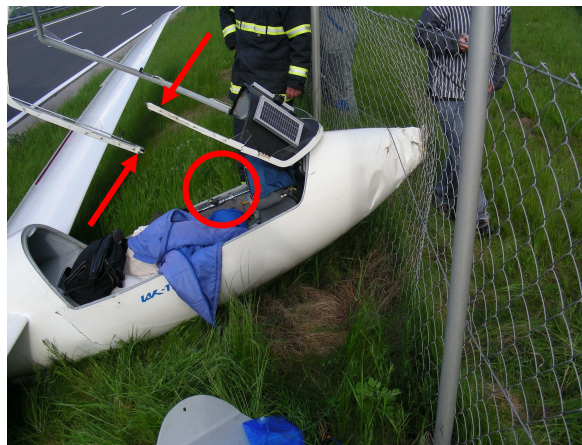
Poškodovan pokrov pilotske kabine in struktura
