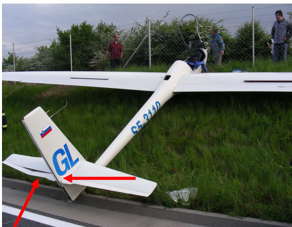
Poškodbe višinskega in smernega krmila
