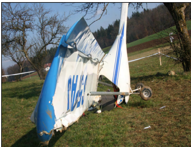
Slika 3. Poškodbe levega krila
