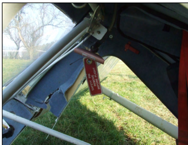
Slika 10. Poškodbe okvirja pilotske kabine
