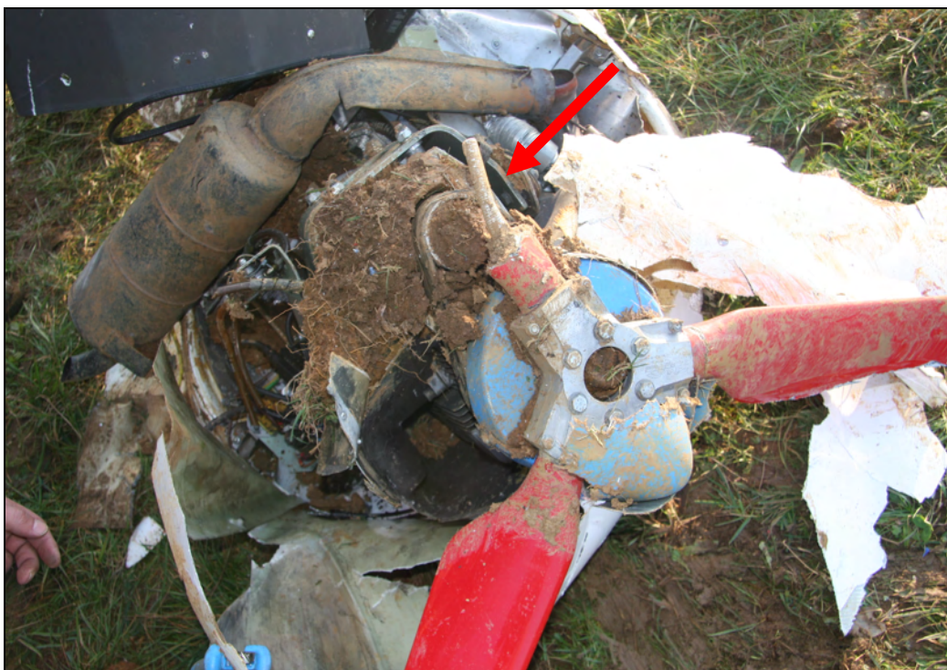
Slika 1. Motor ROTAX 503 UL s poškodovanimi kraki propelerja po trčenju ob tla
