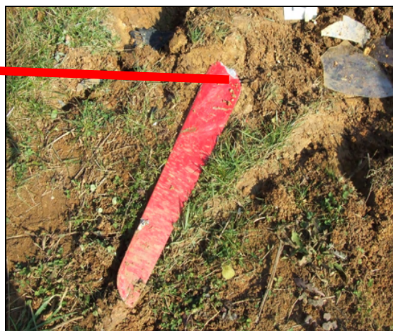
Slika 2. Poškodovan krak propelerja v kraterju trčenja
