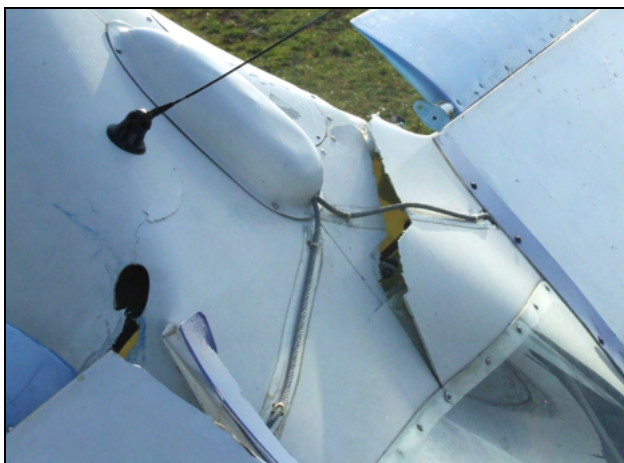
Slika 5. Poškodbe zgornjega centralnega dela
