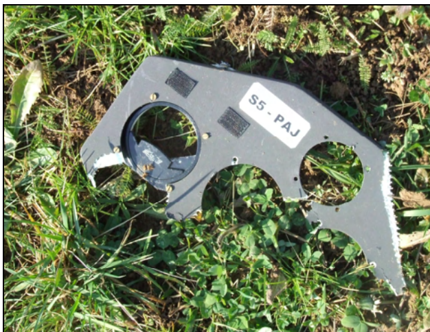
Slika 7. Del poškodovane instrumentalne plošče
