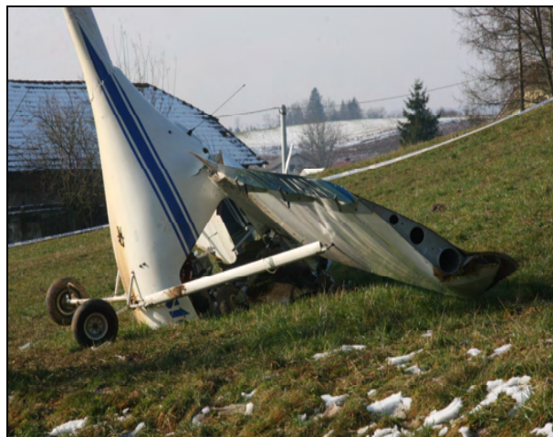
Slika 4. Poškodbe desnega krila
