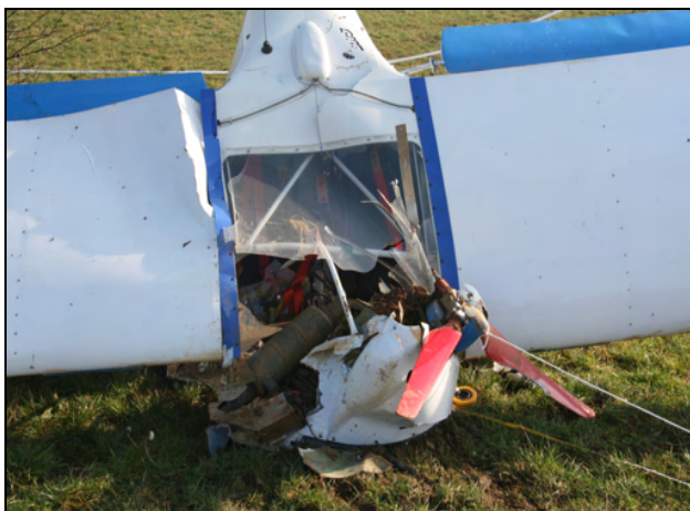
Slika 1. Poškodbe centralnega dela letala in motorja
