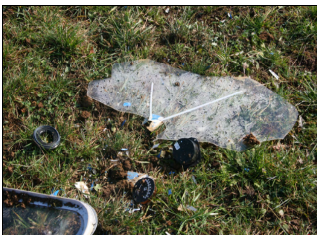
Slika 9. Poškodovani deli iz pilotske kabine
