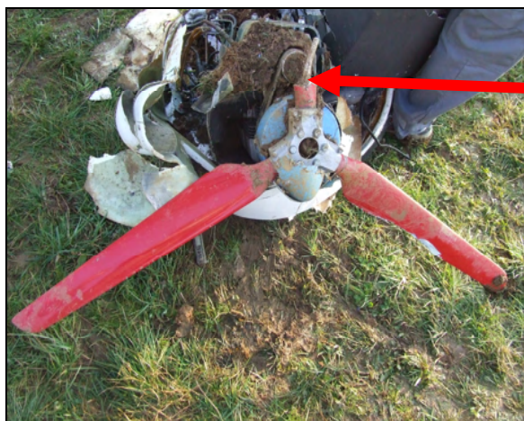
Slika 1. Poškodovana kraka propelerja po trčenju
