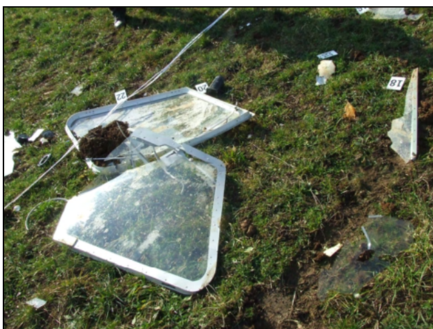
Slika 11. Poškodovana vrata pilotske kabine
