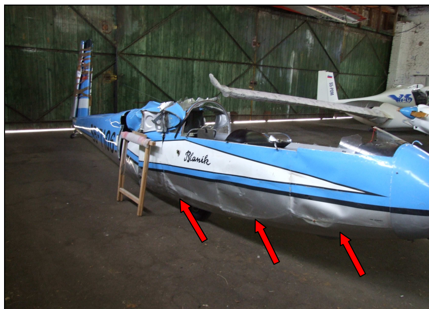
6. Poškodbe okvirjev št. 2,3 in 4 ter strukture med njimi
