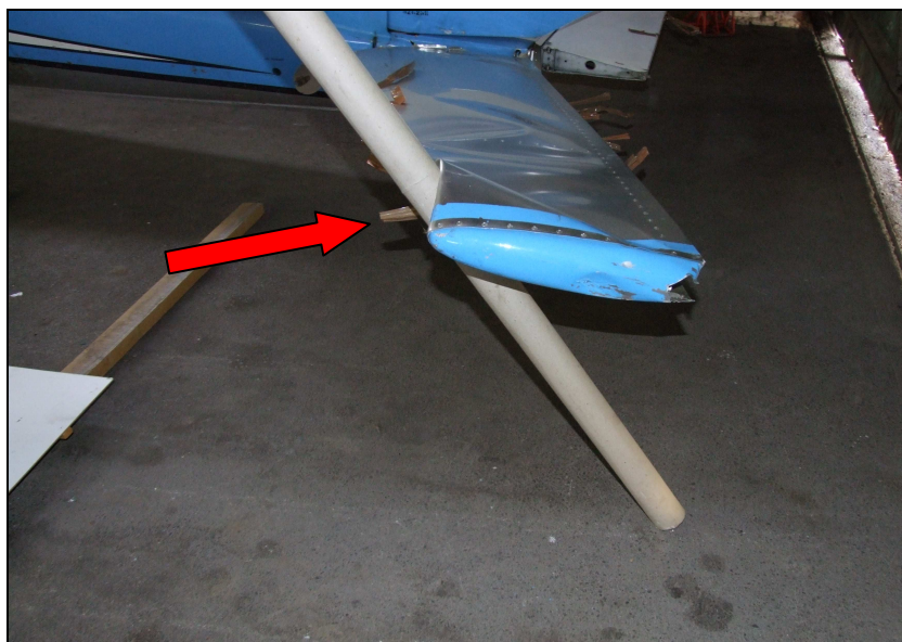
13. Na levem stabilizatorju je odlomljen prednji nosilec in odtrgano višinsko krmilo
