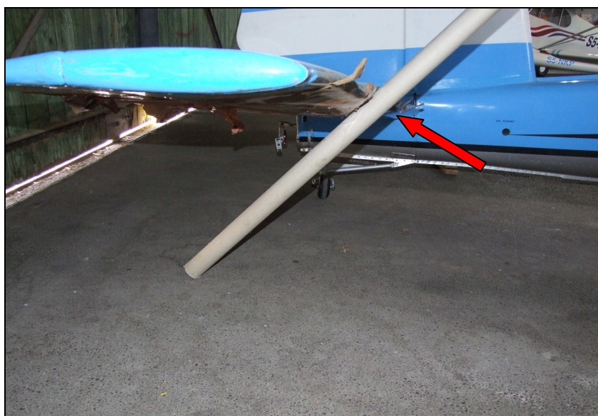
14. Levi in desni višinski stabilizator sta močno poškodovana
