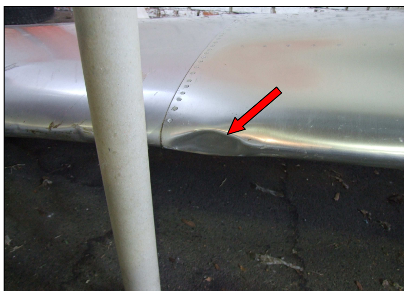
11. Sled udarca na rebru št.25
