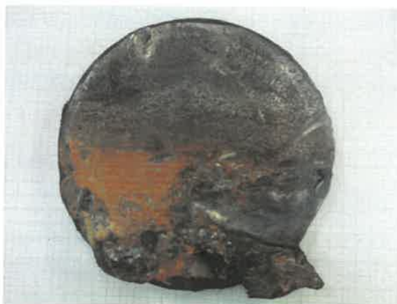
Slika št. 9: Prelomna površina osi, ki je izdrta iz pesta monobloka
