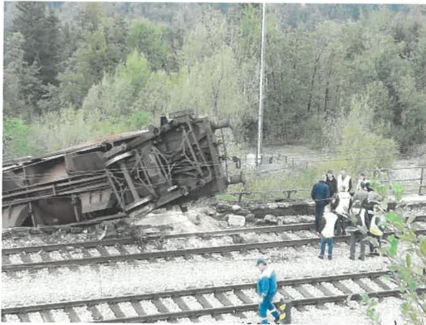
Slika št. 5: Iztirjen vagon št. 31 79 082 2125-0 po zaustavitvi na brežini ob tiru št. 4 postaje Verd, v km 597+700
