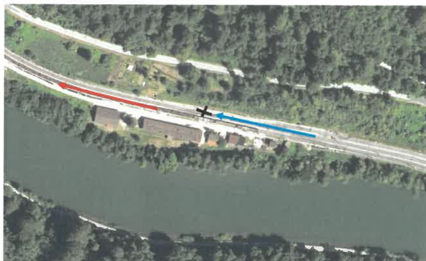
Slika št. 1: mesto iztirjenja označuje črni križ smer vožnje vlaka št. 43601 pred iztirjenjem modra puščica, rdeča pa smer tir po na katerega bi moral vlak zapeljati preko kretnice št. 25
