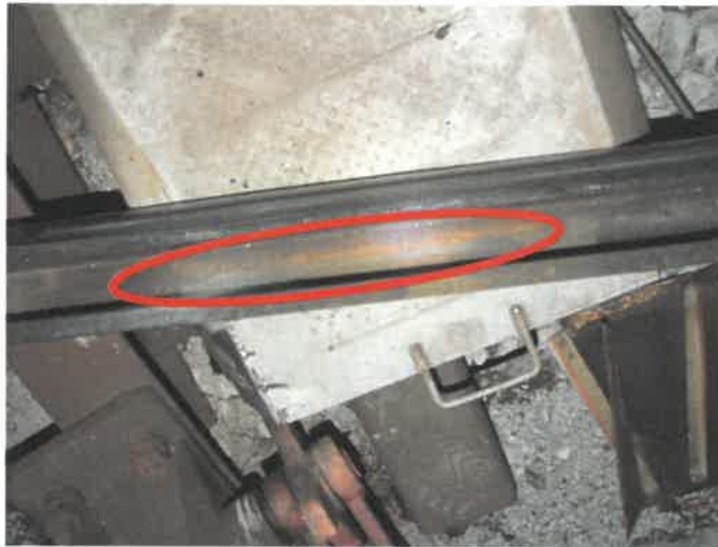
Slika št. 6: V rdečem rombu je prikazan proizvajalec in letnica izdelave zlomljene ostrice kretnice (proizvajalec Krupp, letnica izdelave 1987)
