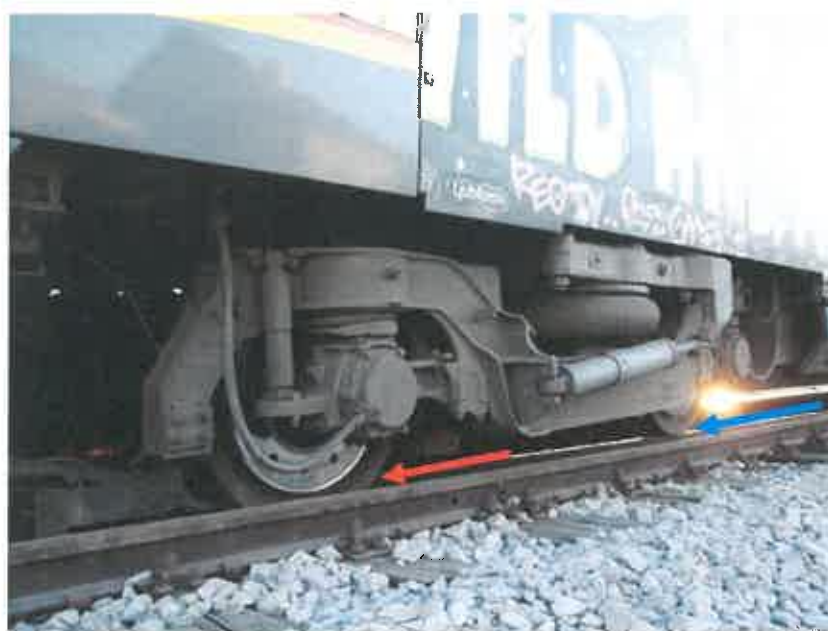
Slika št. 2: Rdeča puščica prikazuje iztirjeno desno kolo prve osi lokalnega potniškega vlaka št. 2402 na kretnici št. 12 postaje Škofja Loka, modra pa pravilno navoženo desno kolo druge osi prvega podstavnega vozička
