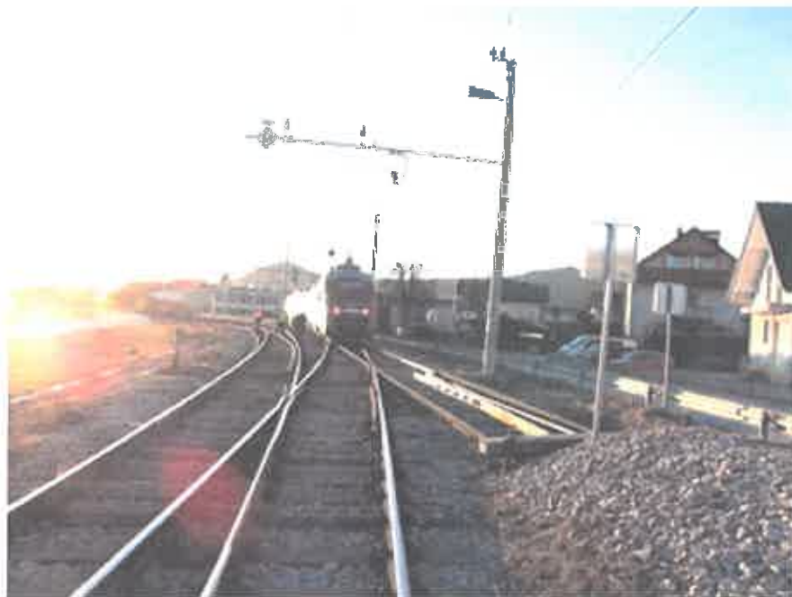
Slika št. 5: Prikaz mesta ustavitve vlaka št. 2402, po iztirjenju na kretnici št. 12
