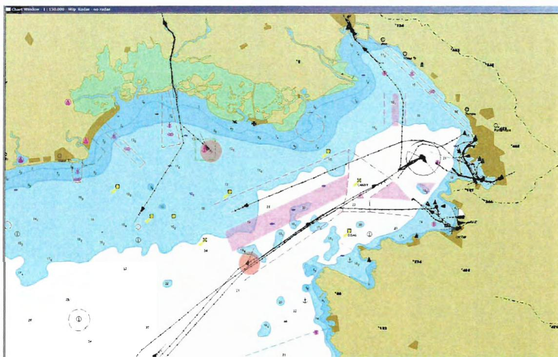
Slika 34: Napačni prikaz ladijske premčnice (zelo pogost pojav)
