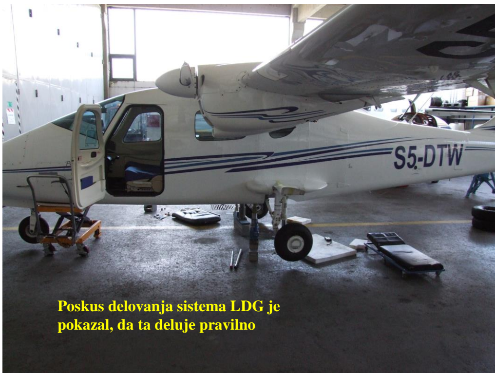
Slika 4: Preverjanje funkcionalnosti LDG
