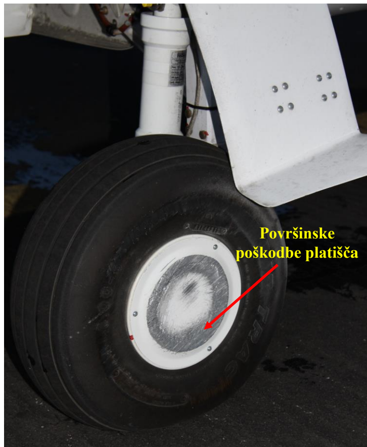
Slika 6: Površinske poškodbe platišča (nastale ob drsenju z asfaltno površino VPS)
