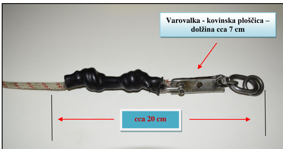
Iskani del vlečne vrvi je dolžine približno 3m do 4m z varovalko podobno kot na sliki
