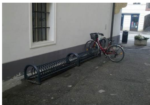
Slika 89: Neprimerna kovinska stojala, ki omogočajo priključevanje le enega kolesa (Gregor Steklačič)
