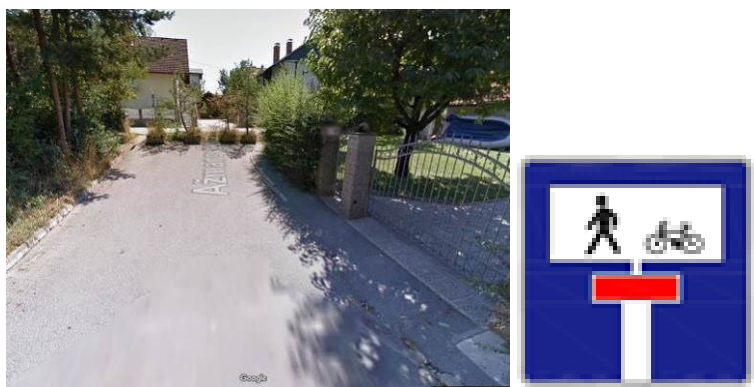
Slika 42: Sprememba tranzitne ulice v slepo ulico, ob robovih so prehodi za kolesarje in pešce (Vir: GoogleMaps), kombinacija s prometnim znakom na vstopu v ulico 3204-4
