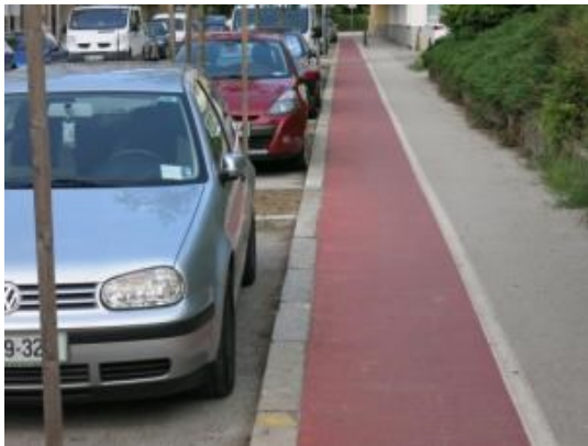
Sliki 25 in 26: Primer neustrezne izvedbe ločenih pasov za pešce in kolesarje (brez odmika med kolesarsko stezo in parkirnimi prostori - robnikom) (Lep et al.)
