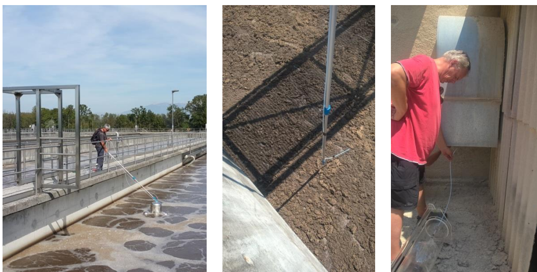
Slika 8. Emisijski vir (biofilter) in sistem za zajem vzorcev iz površinskih virov, objekt za skladiščenje odpadnega blata in objekt za predelavo živalskih kož.
