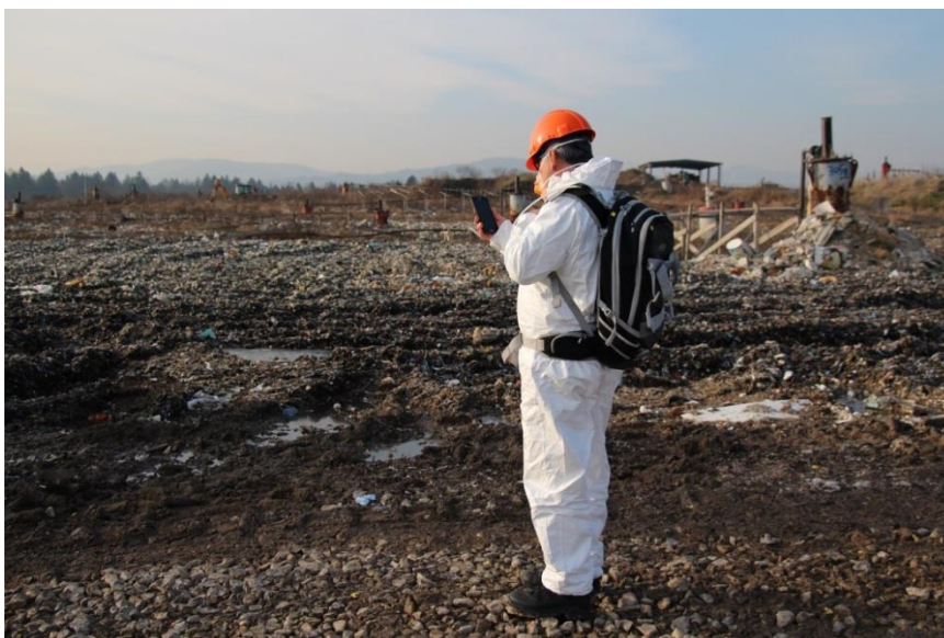
Slika 10. Meritve koncentracij vonja na terenu s prenosnim olfaktometrom.
