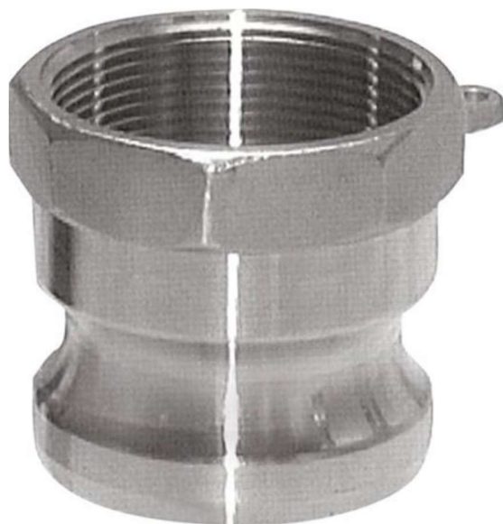
Slika 11: Fotografija hitre spojke s priključnico z notranjim navojem, tip A. Ta "adapter" se je uporabljal za povezavo med navojnim priključkom na dnu ISO kontejnerja in ženskim delom Kamlock priključka na gibljivi cevi pretakališča za epiklorohidrin. Vir: Poročilo Melamin/IJS/SIQ
