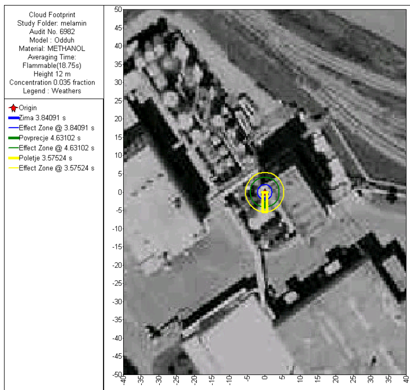
Slika 10: Prikaz dosega polovične koncentracije spodnje eksplozijske meje za hlape metanola v smeri vetra za tri meteorološke situacije (izpust iz odduha dest. kolone; napram situaciji lokacije).
