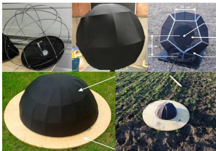
Slika 3: Sekundarne vetrne zaščite z uporabo konstrukcije žic/palic in tkanine, [2,3,6,9].
