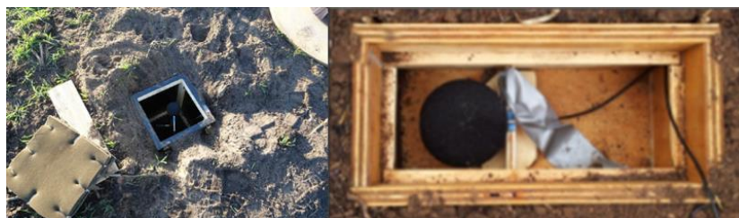
Slika 4: Sekundarna vetrna zaščita v obliki okvirja v zemlji, prekrita z zaprto celično peno, [9, 10].
