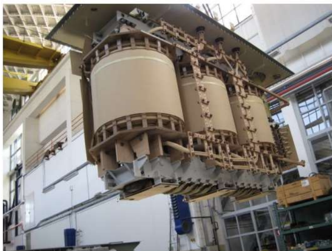
Slika 1.1.b: Prikaz aktivnega dela transformatorja
