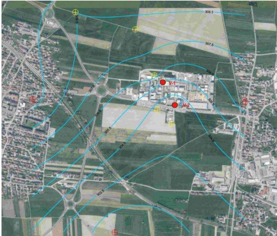
Slika 13: Hidroizohipse v deževnem obdobju (Poročilo št. GA 3002/25, januar 2025)
