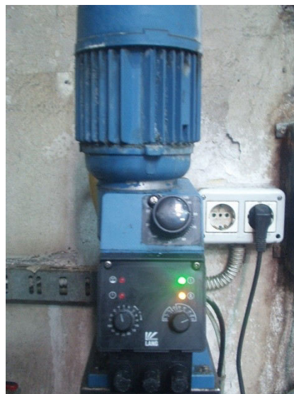
Slika 21: Instrument za nadzor procesne raztopine ter naprava za avtomatsko doziranje razmastilno-fosfatirnega sredstva.
