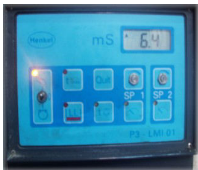
Slika 21: Instrument za nadzor procesne raztopine ter naprava za avtomatsko doziranje razmastilno-fosfatirnega sredstva.
