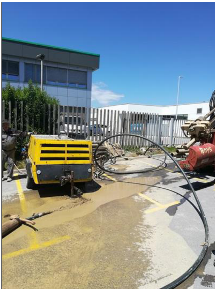
Slika 7. Primer airlift-a na piezometru PL-1/21.
