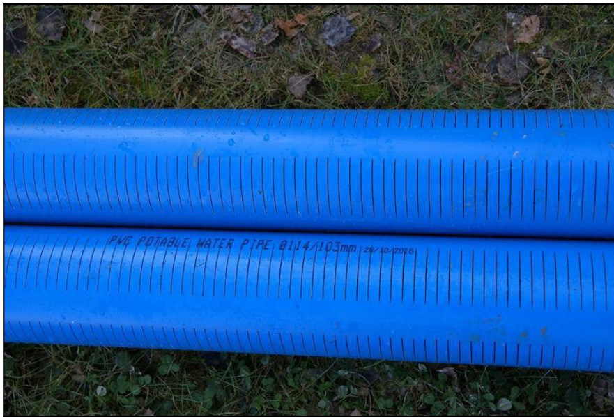
Slika 3. PVC cevinev piezometra 114/103 mm. Na sliki je filter s 1 mm režo.
