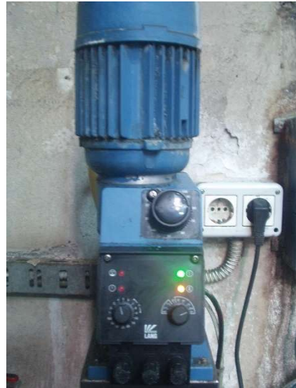
Slika 21: Instrument za nadzor procesne raztopine ter naprava za avtomatsko doziranje razmastilno-fosfatirnega sredstva.
