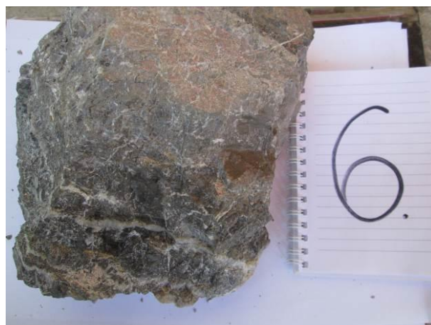
Slika 15: Kompakten dolomit s kalcitnimi žilami.
