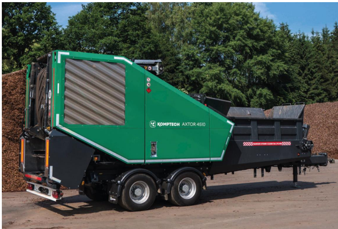
Slika 5: KOMPTECH AXTOR 4510 drobilec lesne biomase in odpadkov./1/
