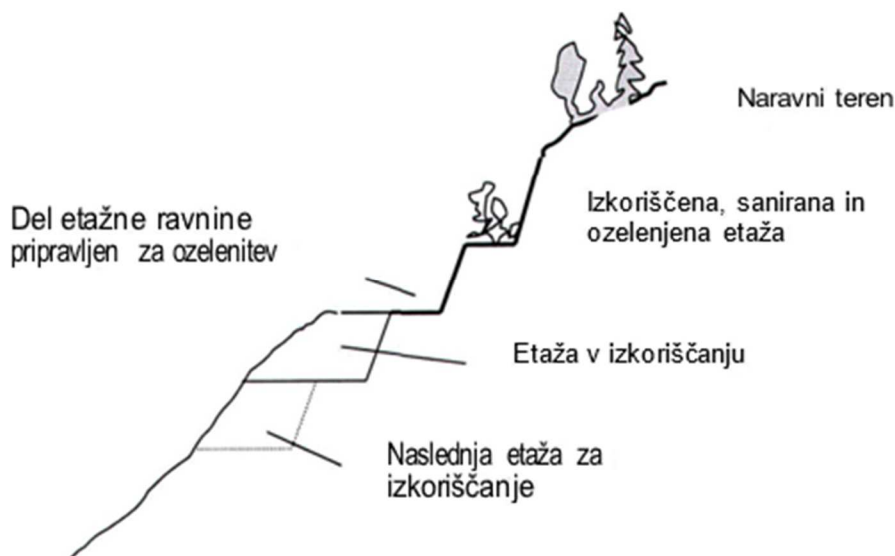
Slika 3: Shematski prikaz odkopavanja
