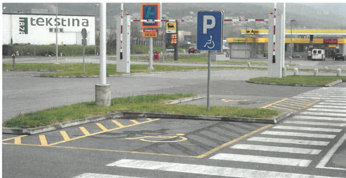
Slika 27: Parkirišča za invalide. Ustrezno označeno parkirišče (z znakom in talnimi označbami), ki je z označeno potjo ustrezno povezano z vhodom v stavbo.
