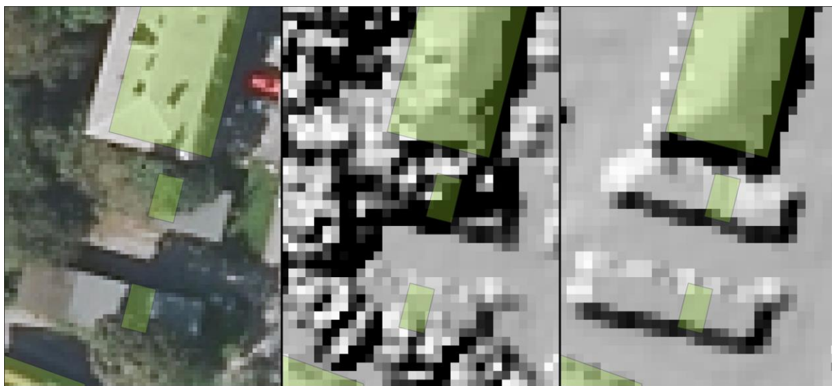
Slika 14: Primer zaznane spremembe: ortofoto (levo), lidarski oblak točk brez odstranjene vegetacije (sredina) in lidarski oblak točk z odstranjeno vegetacijo (desno).
