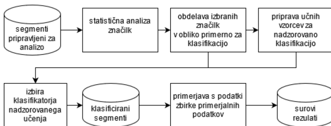
Slika 10: Proces objektno usmerjene klasifikacije: od segmentov do surovih rezultatov
