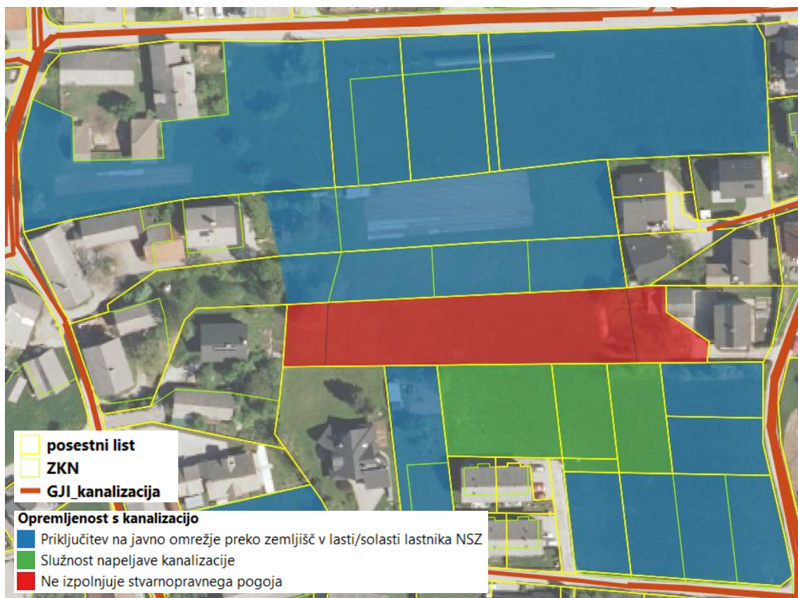
Slika 20: Možnost priključitve NSZ na javno kanalizacijsko omrežje
