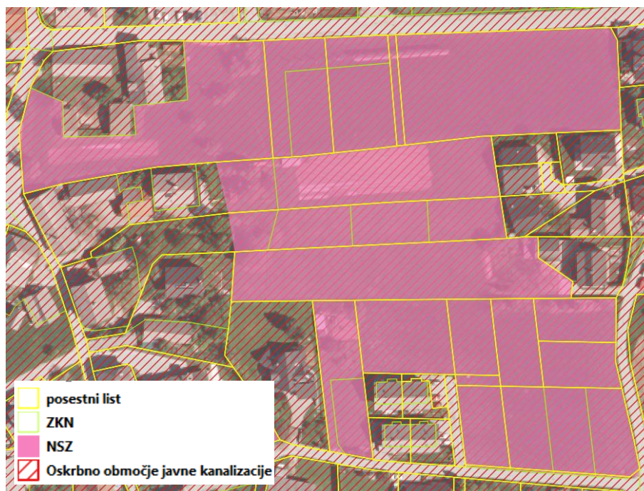
Slika 18: Oskrbno območje javne kanalizacije na izbranem primeru
