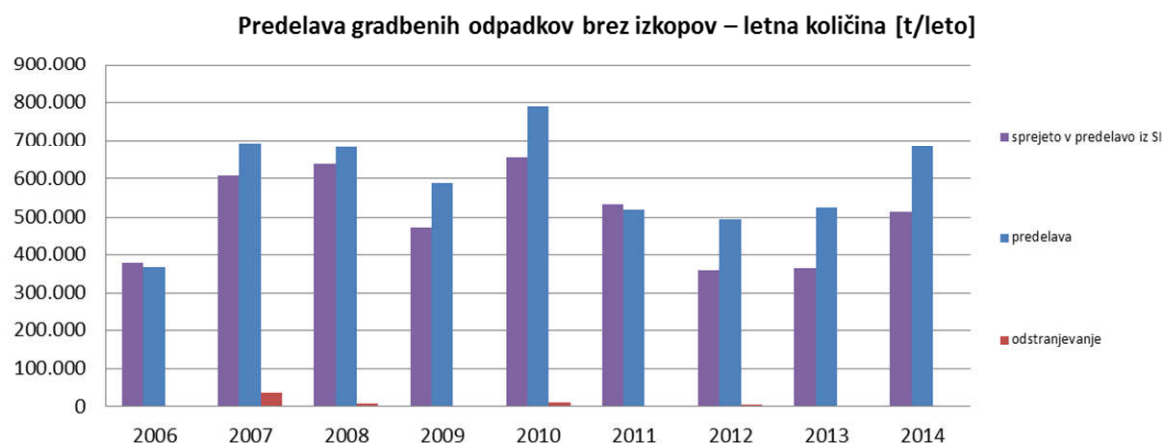
Slika 54: Predelava gradbenih odpadkov brez izkopovih materialov; obdobje 2006-2014 (vir: ARSO, SURS-ODP in ODP-P)
