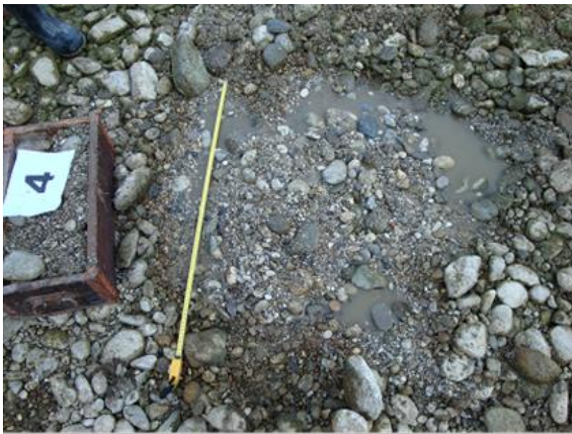
Slika 82: 7PRODNI VZOREC V STRUGI KRKE PRI JEKLENEM MOSTU PRODNO TELO SIPINE POD POVRŠJEM KAŽE SORAZMerno VELIK DELEŽ DROBNIH FRAKCIJ (FOTO D.C.)
