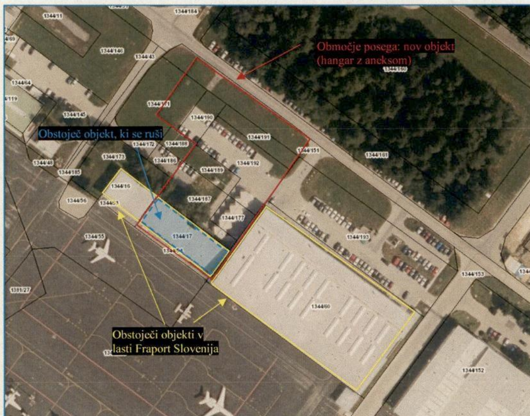
Slika 1.3.a: Informativni prikaz lokacije posega na ortofoto posnetku [4]
